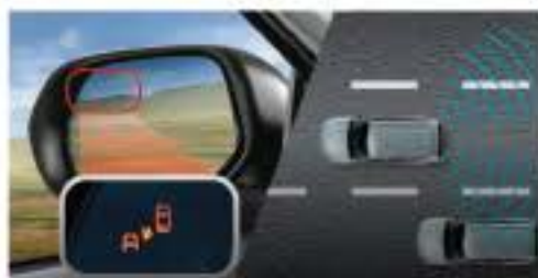
SENSOR KENDARAAN TAK TERLIHAT BSW 1 BLIND SPOT WARNING
